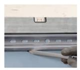
Die Rinnenschiene kann mit Neigung in Richtung Ablauf angebracht werden.
