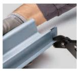
... und z.B. mit einer Blechschere oder einem Blechknabberer ausgeschnitten.
