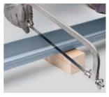
In der Regel wird zum Ablängen der Rinne eine Eisensäge verwendet.
