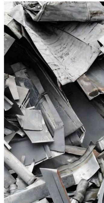
Die Menge an Sekundärzink im Produkt wird im Wesentlichen bestimmt durch Produktions- und Neuschrotte, die sämtlich bei RHEINZINK wieder eingeschmolzen werden. Dieser Anteil beträgt ca. 30-40%. Da normgemäß kein externes Sekundärzink als Vormaterial eingesetzt werden darf, sind die Möglichkeiten zum Ausbau des Sekundärzinkanteils derzeit begrenzt. Der Sekundärzinkanteil im Primärzink liegt derzeit bei ca. 14% (Quelle: International Zinc Association).
