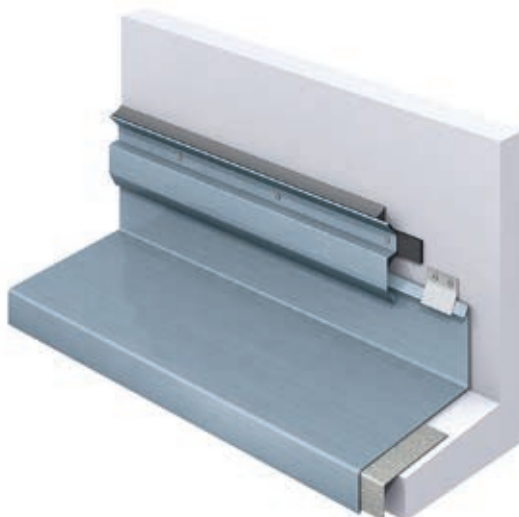
Skizze 27: Aufgesetzte Kappleiste mit Dichtband und Fugendichtstoff
