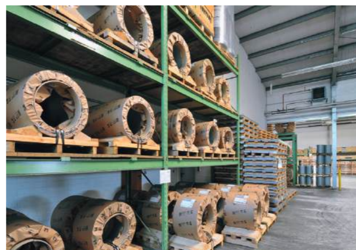
Lagerung Coils mit Lagerhölzern
