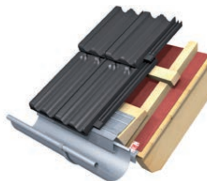
Belüftung unterhalb der Rinne, Anschluss der Unterspannbahn an Tropfblech
