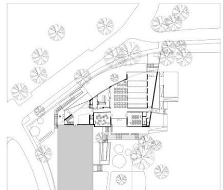
Der Grundriss zeigt, wie das kompakte Gebäude mit seiner leichten Rundung an der Nordfassade den verfügbaren Raum maximal ausnutzt und zugleich den südlich anschließenden Hof gegen die Straße abschirmt.
