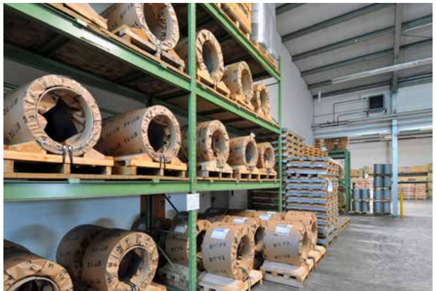
Lagerung Coils mit Lagerhölzern
